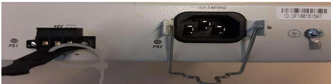
Orange Mobile a besoin de sécuriser l'alimentation électrique de l'ETX-2i-10G-B. Il faudra raccorder les deux types d'alimentation pour la sécurisation.
